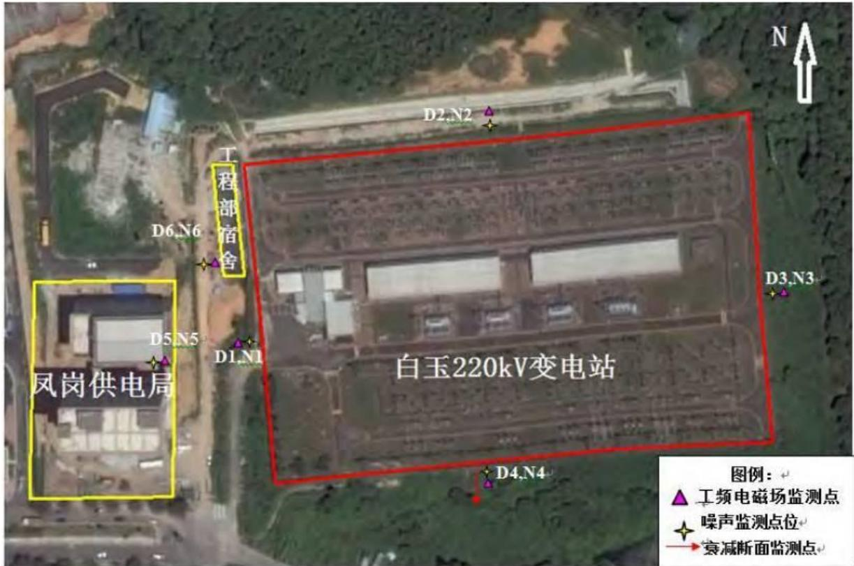
图 2 220kV 白玉变电站工频电场、工频磁场监测布点示意图
