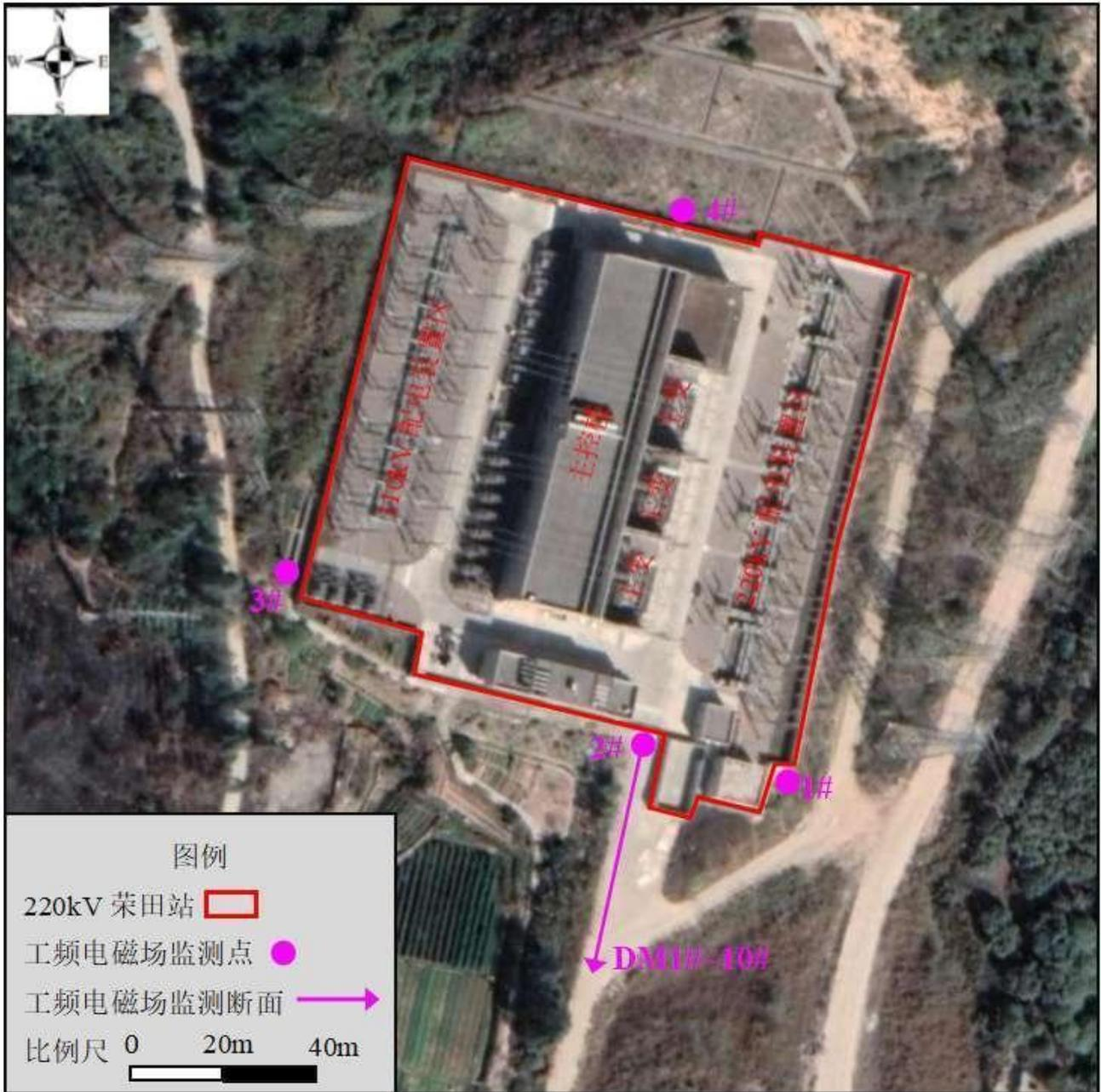
图 3 220kV 荣田变电站工频电场、工频磁场监测布点示意图
